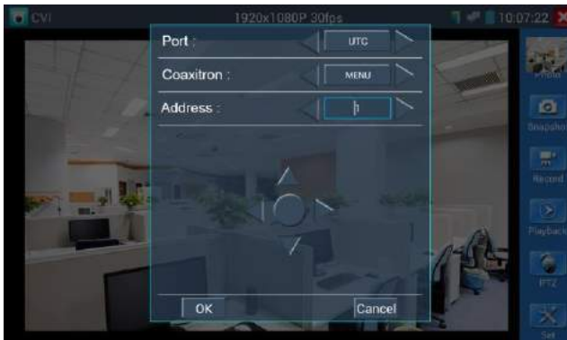
Рис.3.3.6.-5 Установка параметров протокола Coaxitron
