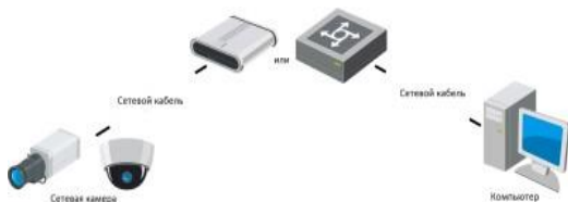
Рисунок 3-2 Подключение через коммутатор или роутер
