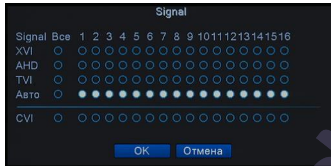
Рис. 3.17 Установка стандарта AHD/TVI/CVI
