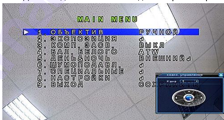
Рис. 3.16 Управление по коаксиалу
