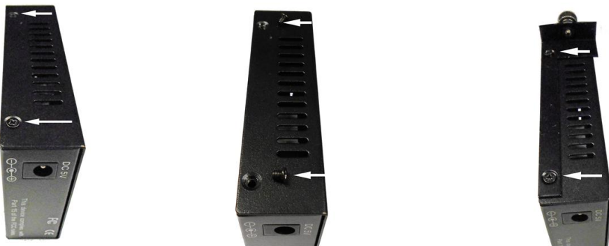
Рис. 4 Установка крепления под винт на корпус медиаконвертера
