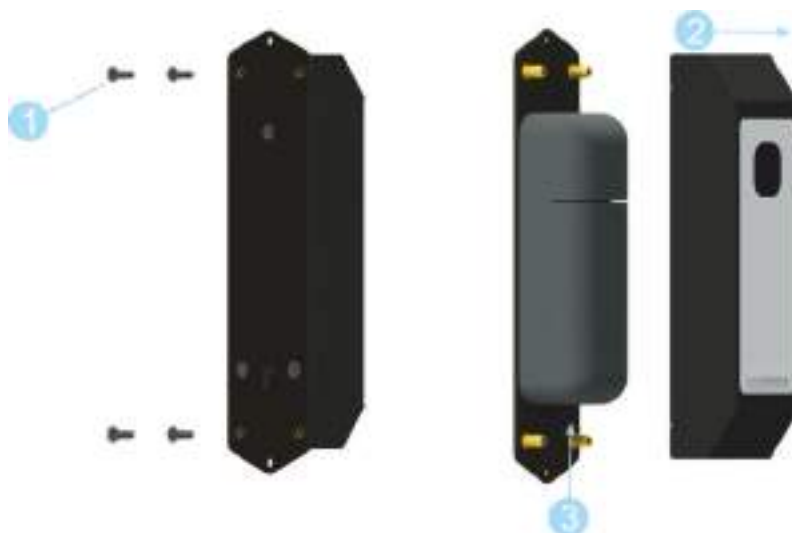
Рисунок 6.7.1.5 Разбор корпуса датчика
