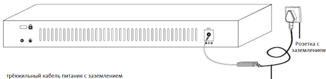
Рисунок 2.9 Заземление с использованием трехжильного кабеля питания
