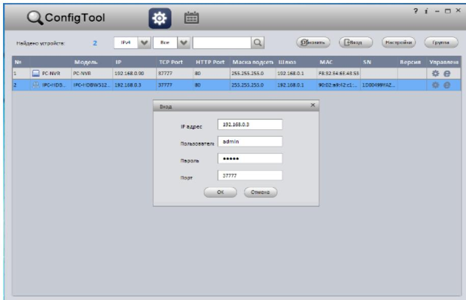
Измените IP-адрес камеры в “Сетевом” интерфейсе, нажмите кнопку “Сохранить”, чтобы завершить изменение. На рисунке ниже представлены базовые параметры для изменения.
