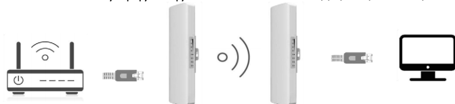
Рис. 4. Схема подключения «Точка-точка»
