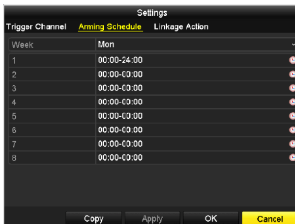
Рисунок 8-3 Установка расписания постановки на охрану обнаружения движения
