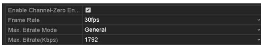
Рисунок 3-10 Просмотр в реальном времени - Кодирование нулевого канала
