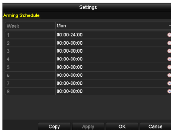
Рисунок 8-17 Установка расписания постановки на охрану тревожного выхода
