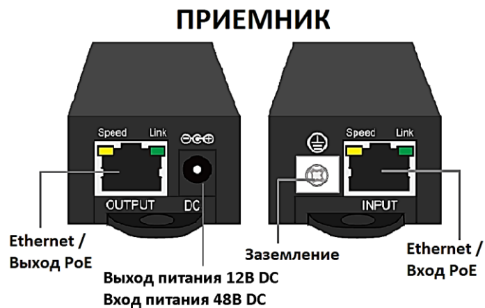
Рис. 2.2. Расположение и назначение элементов коммутации. Приемник.
