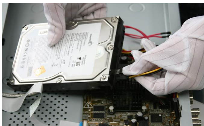
Рисунок 2.8 Подключение кабеля питания
