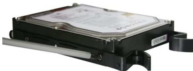
Рисунок 2.1 Закрепление салазок жесткого диска
