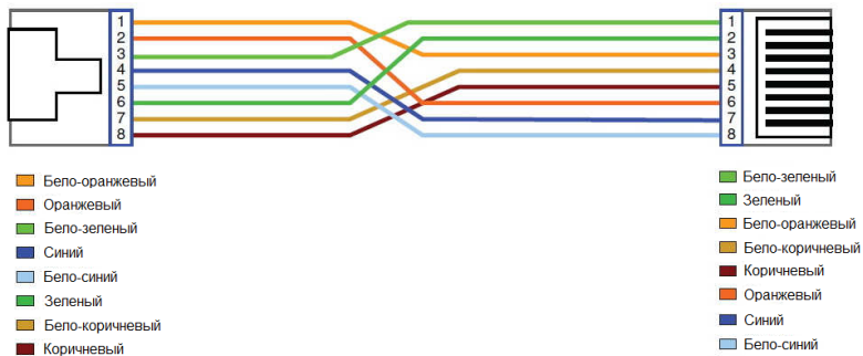
Рис. 9 Обжимка кабеля по типу TIA/EIA-568-B.
