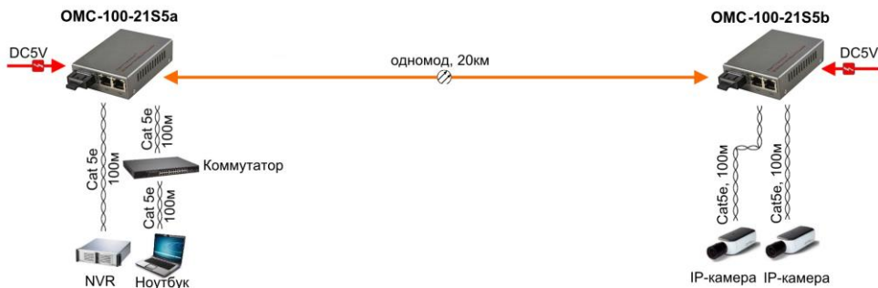
Рис. 7 Схема подключения медиаконвертеров OMC-100-21S5a (OMC-100-21S5b)
