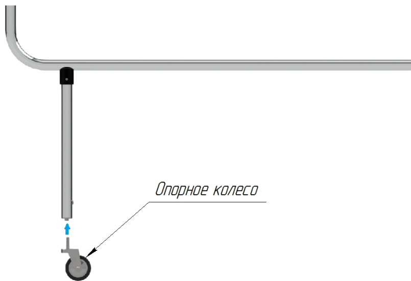
Рисунок 7.2.2 Установка опорного колеса
