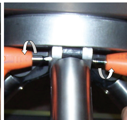
3. Затяните винты (шестигранник 5 мм)
