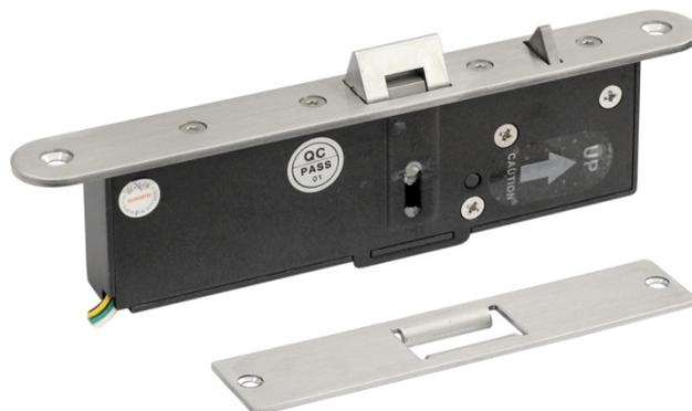
Электромеханический замок ST-DB650M предназначен для работы в составе систем контроля доступа с электронным управлением запираемостью дверей. Замок ST-DB650M является универсальным, т.е. может работать как нормально-закрытый, так и как нормально-открытый. В нормально-закрытом режиме замок разблокируется при подаче питания и блокируется при отключении, а в нормально-открытом режиме разблокируется при отключении питания и блокируется при подаче.
