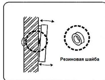
Вставьте шайбы между пластиной якоря (ответной пластины) и дверным полотном. Обеспечив люфт якоря 3-5 мм относительно винта.
