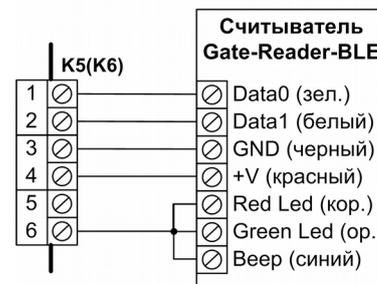
Для подключения рекомендуется кабель UTP с сечением каждого провода не менее 0,22 мм<sup>2</sup>. Сигналы DATA 0 и DATA 1 рекомендуется передавать в отдельных повитых парах с замыканием второго повивающего проводника на GND контроллера СКУД.
