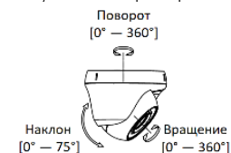
Рисунок 1-15 Настройка угла наблюдения камеры
