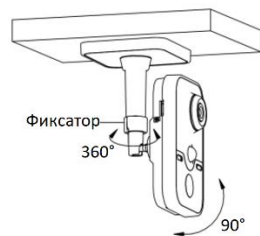
Рисунок 1-25 Настройка угла наблюдения камеры
