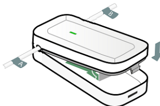
Рисунок 9.6 – Закрытие корпуса датчика
