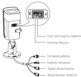
Рисунок 1. Описание цилиндрической камеры
