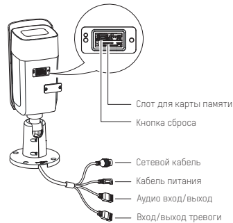
Рисунок 1. Описание цилиндрической камеры
