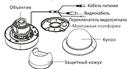
Рисунок 1-13 Купольная камера II типа
