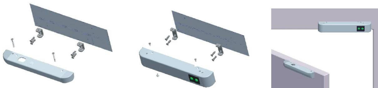
1. Сделайте разметку и зафиксируйте монтажные элементы для замка и ответной части, зазор между замком и ответной частью должен быть порядка 5 мм.
