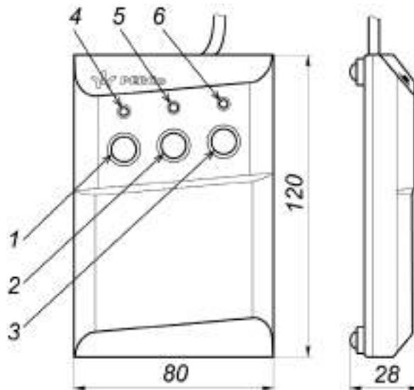
**Рисунок 8. Общий вид и габаритные размеры ПДУ:**
