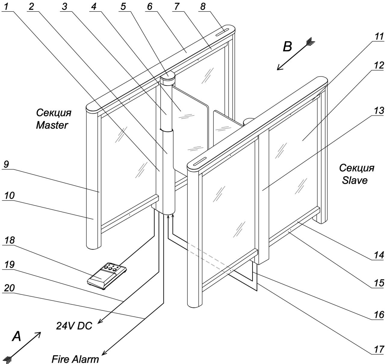
**Рисунок 6. Внешний вид и устройство PERCo-ST-11:**
