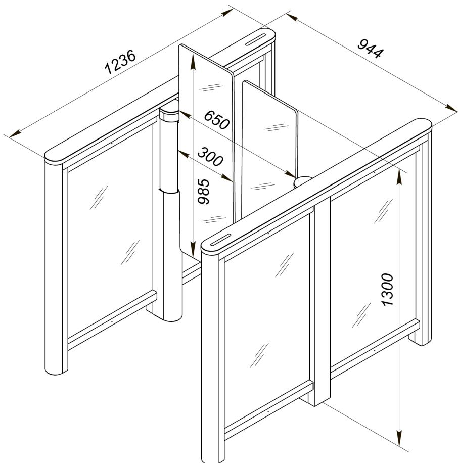
Рисунок 2. Габаритные размеры турникета со створками PERCo-ATG-300H
