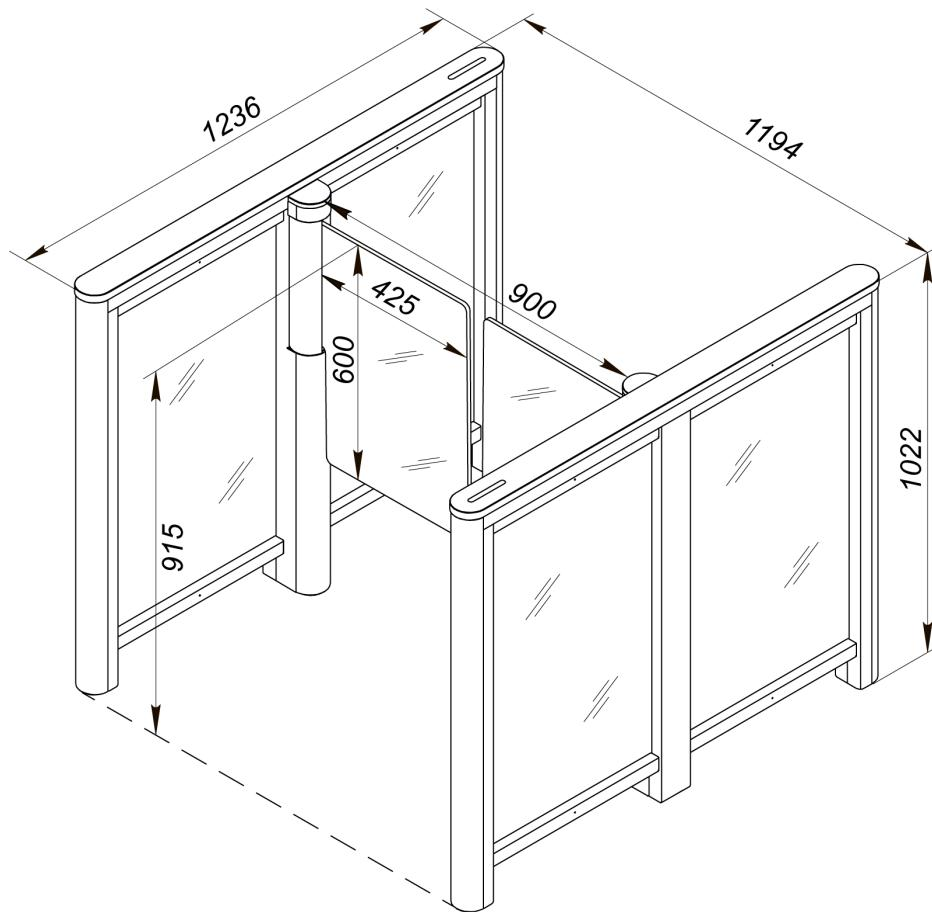
**Рисунок 3. Габаритные размеры турникета со створками PERCo-ATG-425**
