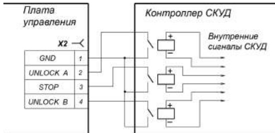
**Рисунок 10. Управляющие элементы внешнего устройства – нормально разомкнутый контакт реле**
