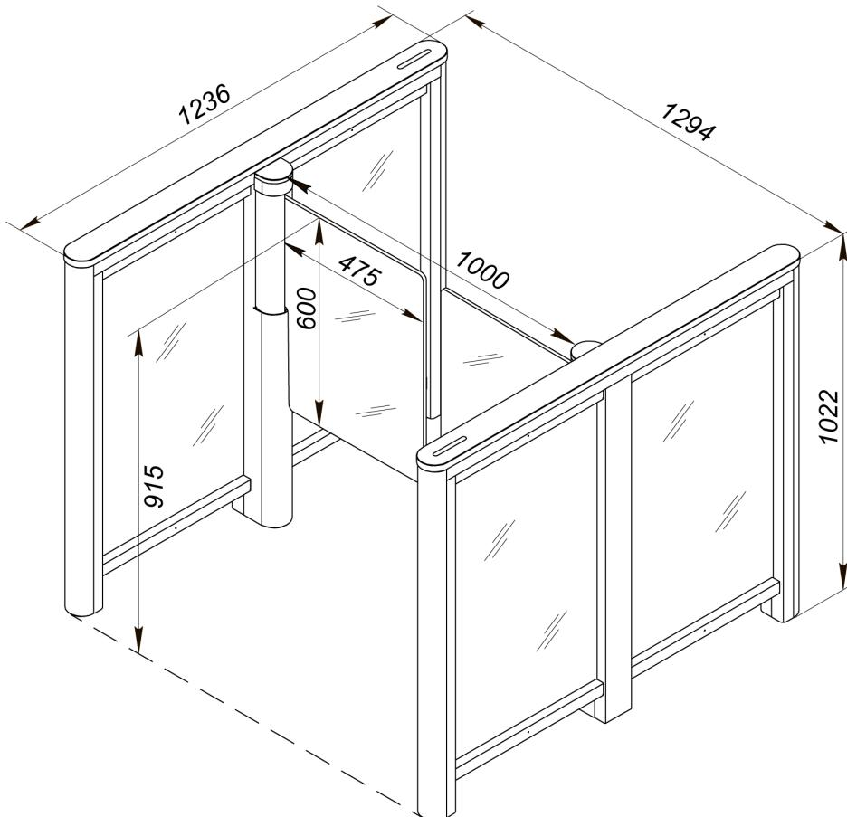
**Рисунок 4. Габаритные размеры турникета со створками PERCo-ATG-475**
