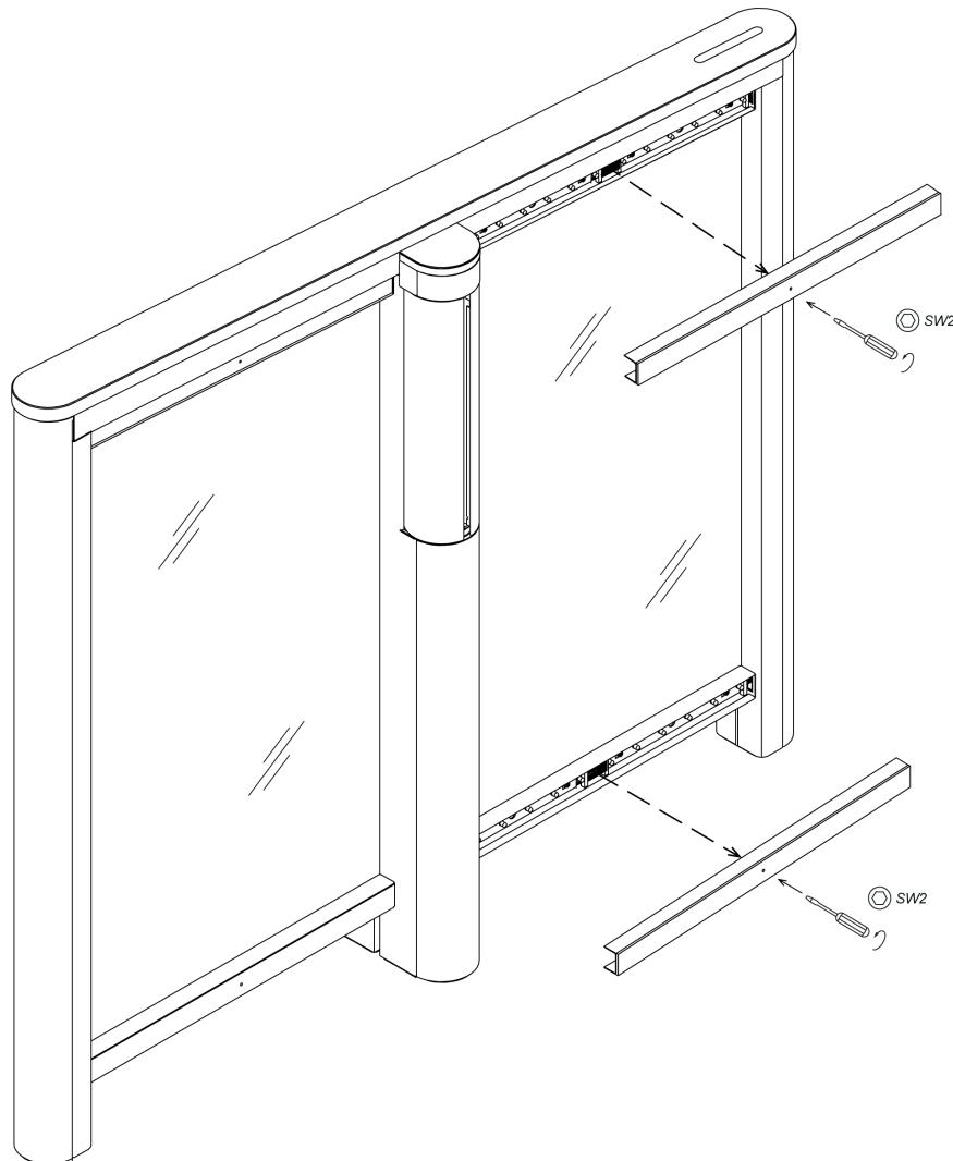
**Рисунок 24. Снятие крышек верхнего и нижнего коробов ДКЗП**
