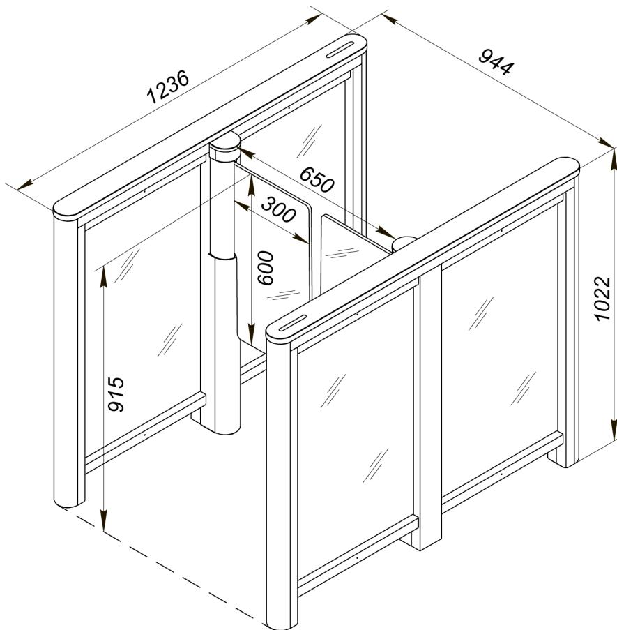
Рисунок 1. Габаритные размеры турникета со створками PERCo-ATG-300
