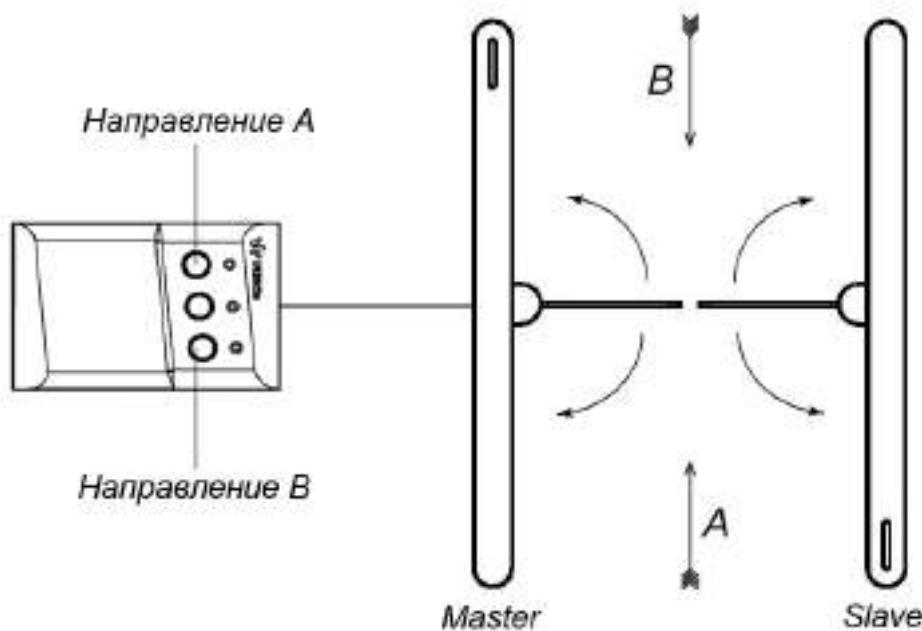
Рисунок 12. Стандартная ориентация ПДУ относительно секций турникута
