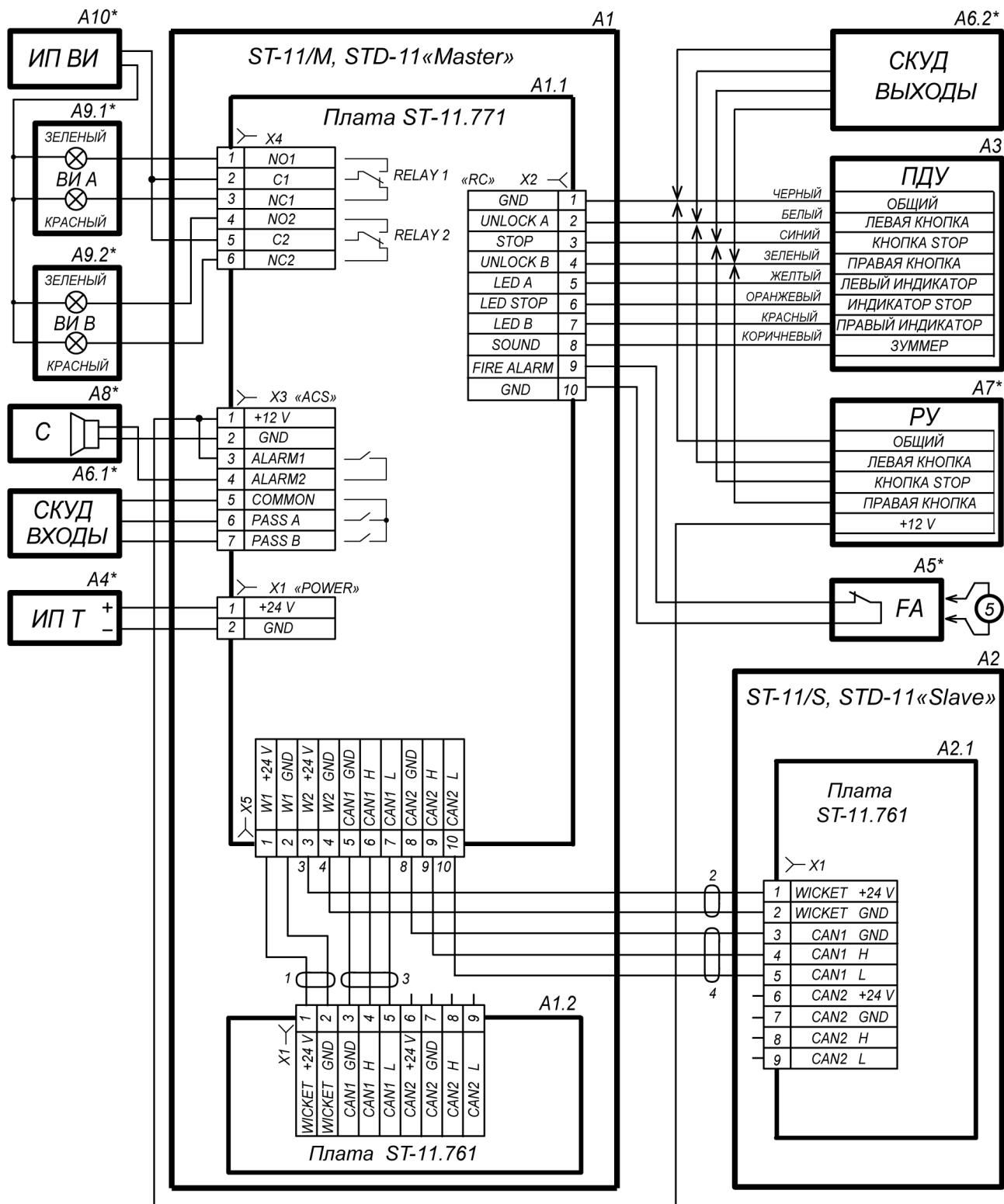
Рисунок 18. Схема электрических соединений турникета<sup>1</sup><sup>1</sup> Перечень элементов схемы указан в табл. 6.
