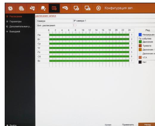
Рисунок 5.34 Настройка расписания с помощью графической схемы.
