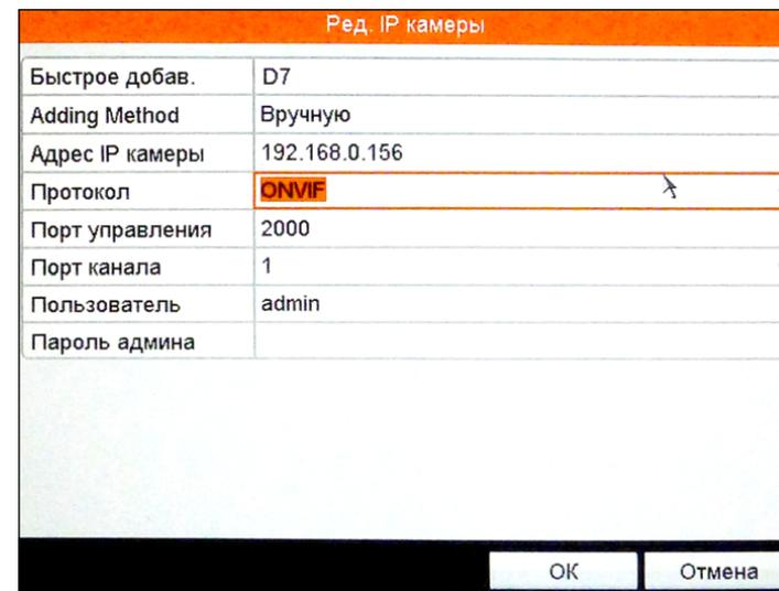
Рисунок 5.42 Редактирование параметров IP камеры.
