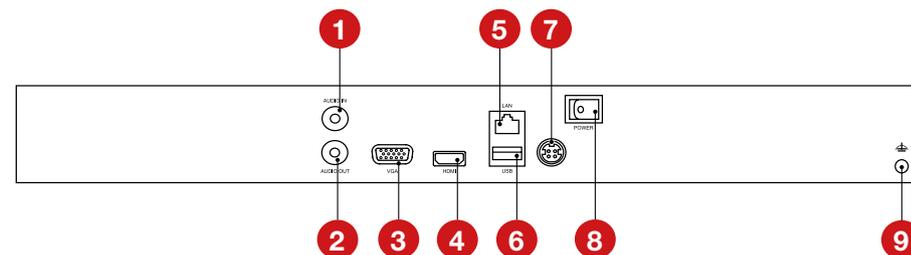
Рисунок 3.8 Задняя панель IP регистраторов (корпус под 2 HDD).
