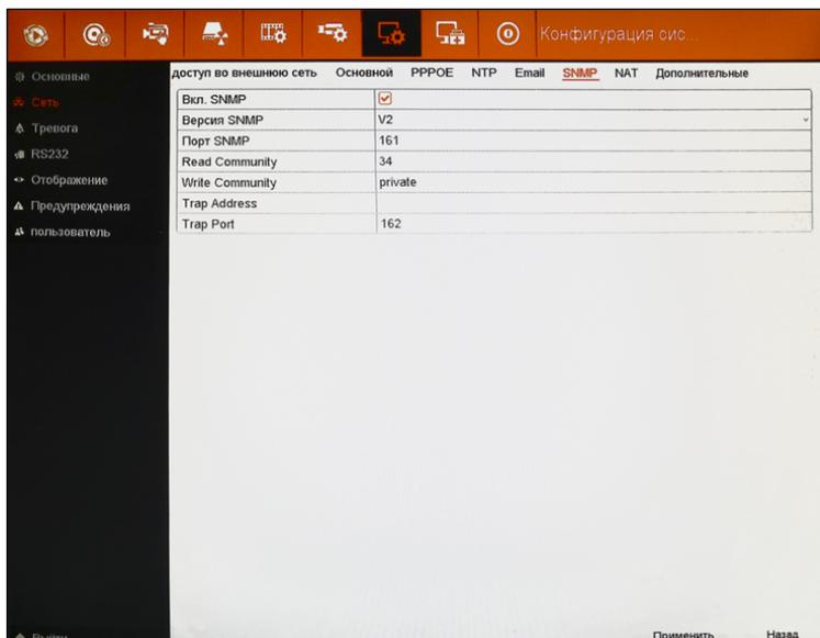
Рисунок 5.77 Настройка SNMP.
