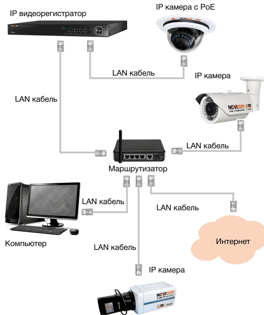
Рисунок 3.13 Подключение IP видеорегистратора с PoE.
