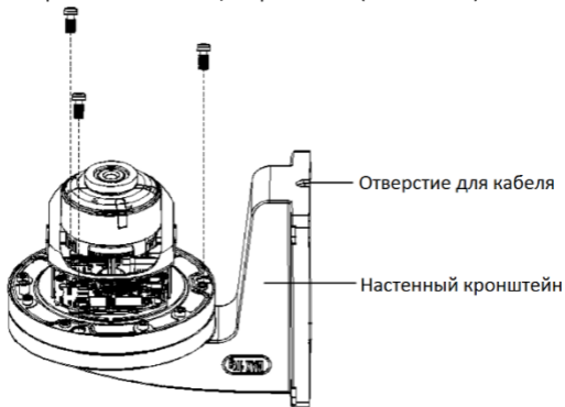
Рисунок 2-11 Установка камеры на настенный кронштейн
