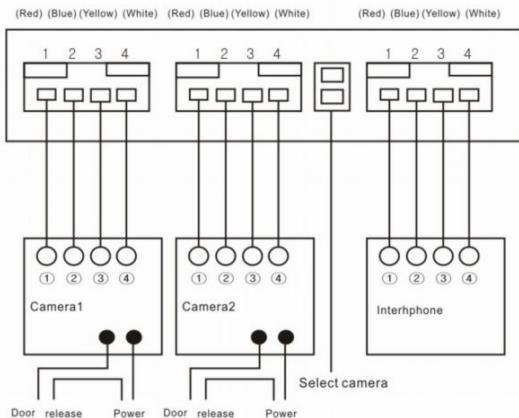
1. 4-контактный разъем, для подключения первой вызывной панели/видеокамеры;
