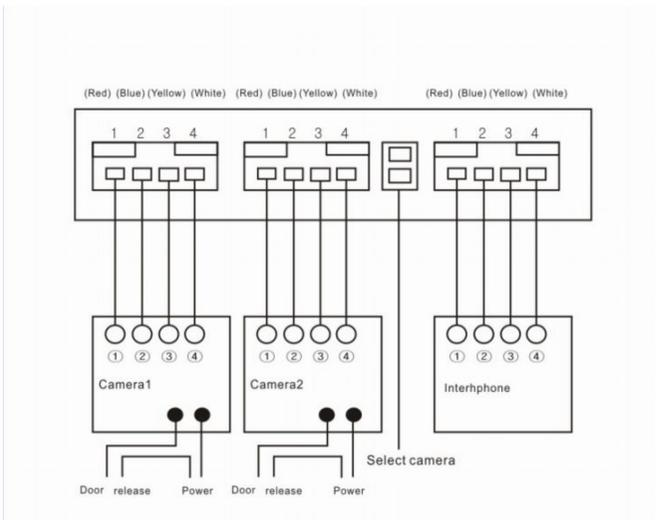
1. 4-контактный разъем, для подключения первой вызывной панели/видеокамеры;
