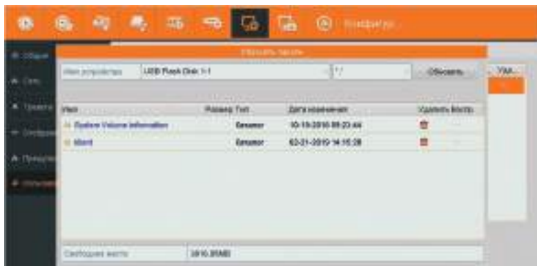
Рис. 50 Экспорт файла GUID на USB носитель
