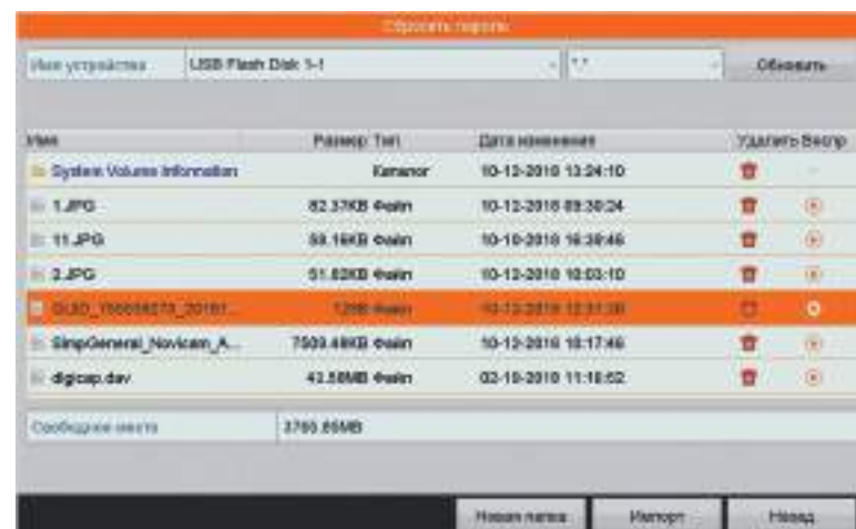
Рис. 53 Импорт файла с USB носителя
