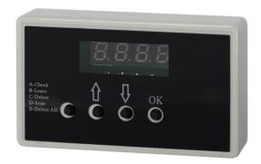
USB пульт программирования для комплекта ST-RC246RRC предназначен для добавления или удаления отдельных передатчиков или программирования режимов работы приемника.
