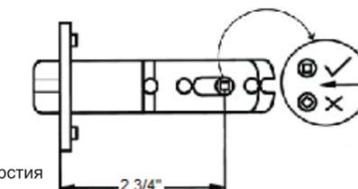
Зазор в позиции 2 3/4" (70мм)
