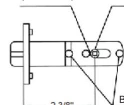
Зазор, это расстояние от края до центра отверстия в передней части двери. По умолчанию, он равен 2 3/8" (60мм).
