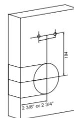
Подберите расстояние в 2 3/8" или 2 3/4" (60мм или 70мм) от края и разметьте центр отверстия на передней части двери, также два отверстия для крепления корпуса замка. (Предоставляется шаблон)
