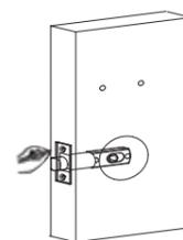
1) Введите ригель в отверстие и удерживайте его параллельно полотну двери. Отметьте контур пластины и снимите его.
