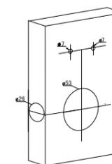
Просверлите 2 1/2" (53мм) отверстие в передней части двери и 1 1/4"(26мм) отверстие для ригеля в торце двери, а также два отверстия 5/18" (7мм) для шурупов.
