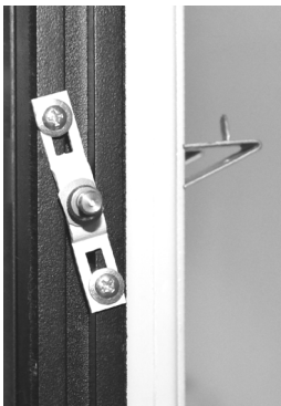
Установка ригеля на POLAIR 1200
