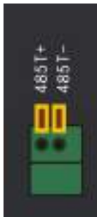
RS485 интерфейс 4 канального регистратора
