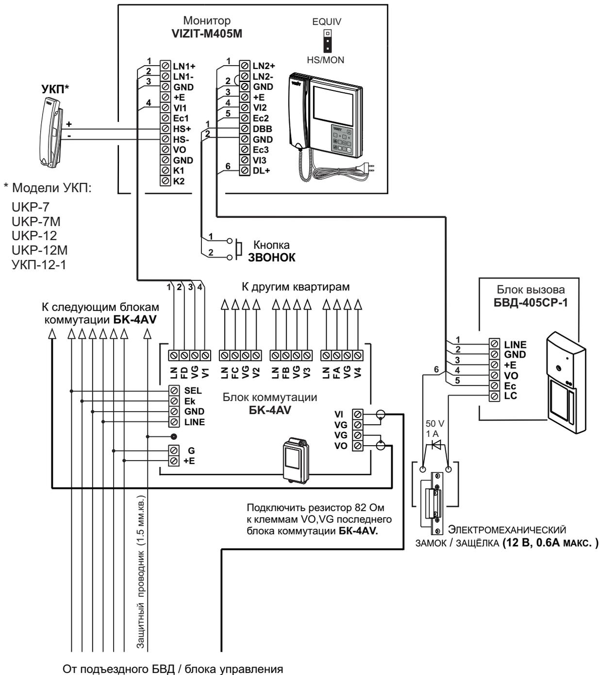
Рисунок 7 - Схема соединений монитора VIZIT-M405M с блоком коммутации БК-4АВ, малоабонентским блоком вызова, дополнительным УКП и кнопкой ЗВОНОК
