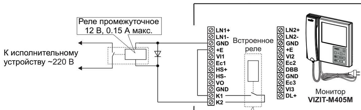
Нормально-разомкнутые контакты встроенного реле могут подключаться непосредственно к входу управления исполнительного устройства, если в этом устройстве обеспечена гальваническая развязка между входом управления и цепями, подключёнными к сети ~220 В
