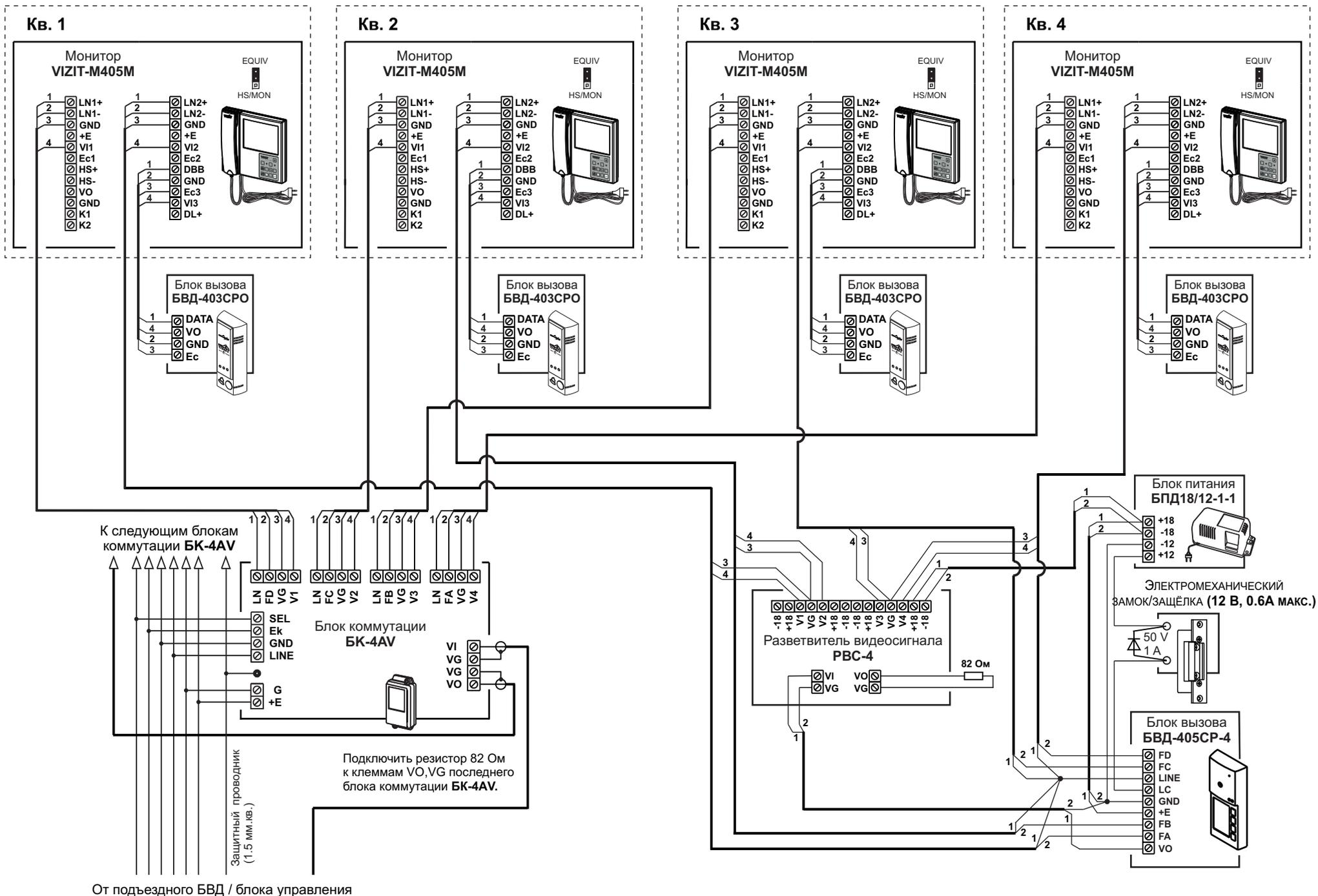
Рисунок 10 - Схема соединений мониторов VIZIT-M405M с блоком коммутации БК-4AV и блоком вызова БВД-405СП-4
