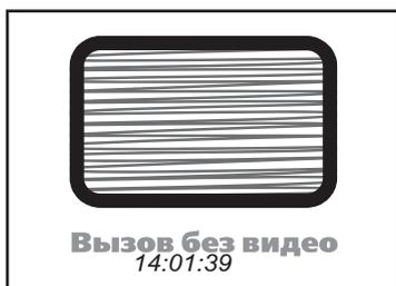
**Примечание.** При нажатии кнопки
