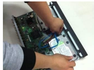
Падключыце SATA кабель і кабель харчавання на ніжняй і задняй частцы корпуса і зачыніце корпус верхняй вешкам.
