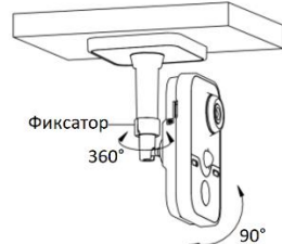
Рисунок 1-27 Настройка угла наблюдения камеры
