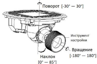
Рисунок 1-25 Настройка угла наблюдения камеры
