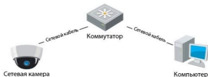
Рисунок 3-2 Соединение через коммутатор или роутер
