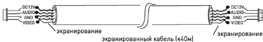
Экранированный сетевой кабель ( \leq 40\text{м} )
