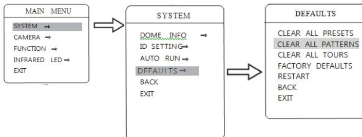
Функция сброса на заводские установки. При сбросе на заводские установки, камера восстанавливает все заводские установки значений, включая все окна и настройки тревог. Будьте осторожны при использовании этой функции!!!
