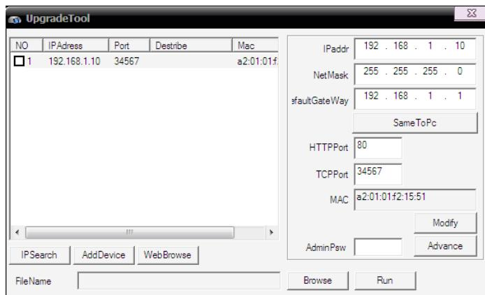
Рис. 2.2 Конфигурация IP
