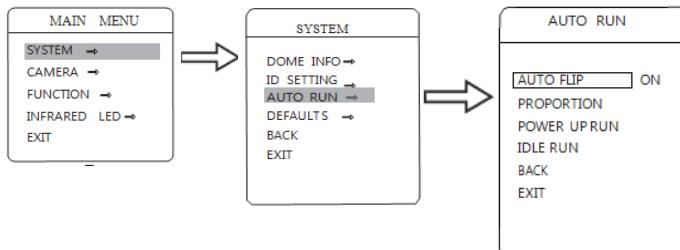
Если пользователь удерживает джойстик в положении наклона вниз (диапазон наклона камеры 186 градусов), камера наклоняется вниз на 90 градусов и переворачивается на 180 градусов, чтобы изображение не оказалось перевернутым, после прохода камерой нижней точки. Пользователь может включить или выключить функцию автопереворота в меню настроек
