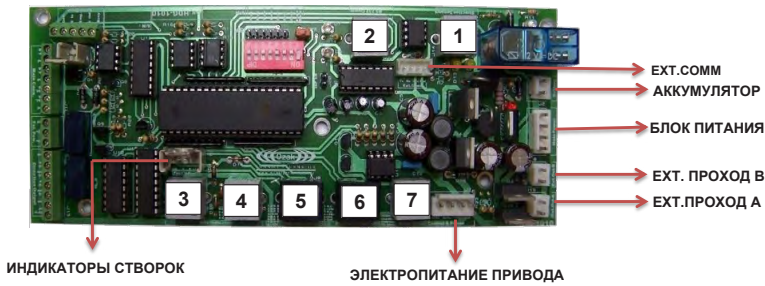
ОСНОВНАЯ ПЛАТА УПРАВЛЕНИЯ HDG-2010
