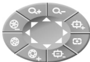
**Панель управления PTZ** – предназначена для управления PTZ модулем камеры. С помощью кнопок на панели управления можно: вращать камеру, изменять угол обзора, настраивать фокус, управлять диафрагмой.
