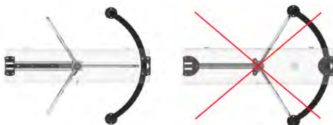
Правильно установленный ротор
