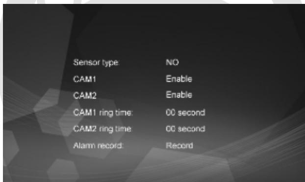
**[Тип датчика]:** Каждый из входов от камер имеет свой тревожный вход (для более подробной информациисмотрите ниже), это значит, что при срабатывании тревоги, на соответствующей камере активируется функция видеозаписи или фотосъемки.
