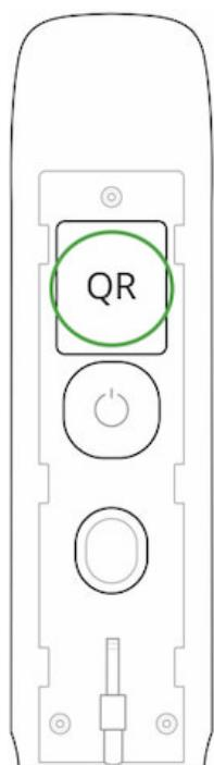
3. Включите устройство, зажав кнопку включения на 3 секунды.
