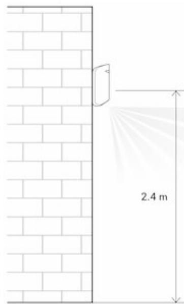
Установка датчика не на рекомендуемой высоте сокращает площадь зоны обнаружения и может сказаться на качестве детектирования движения.
