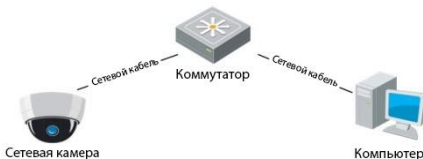
Рисунок 3-2 Соединение через коммутатор или роутер
