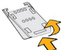
Снимите заднюю крышку, закрывающую отсек для SIM-карты.
