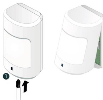
Рисунок 6.2 – Вскрытие корпуса датчика
