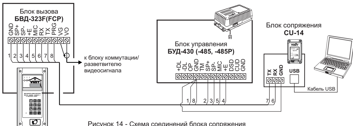
Рисунок 14 - Схема соединений блока сопряжения с блоками управления БУД-430 (-485, -485P)
