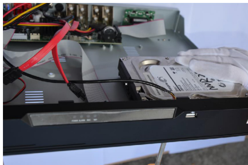
Рис. 11. Установка жесткого диска
