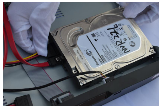
Рис. 12. Установка жесткого диска
