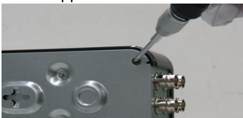
Открутите винты крепления крышки
