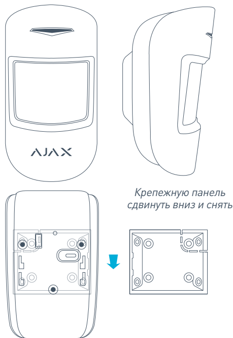
РИС. 1. Датчик движения MotionProtect и его крепежная панель
